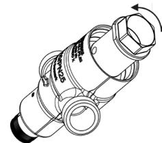
7. Differenzdruckregler aus Ventilgehäuse entfernen
