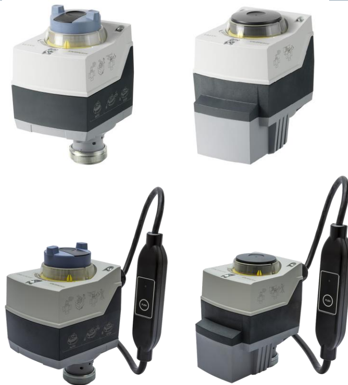
Servomoteurs avec course de 5,5 mm et force de 300 N
