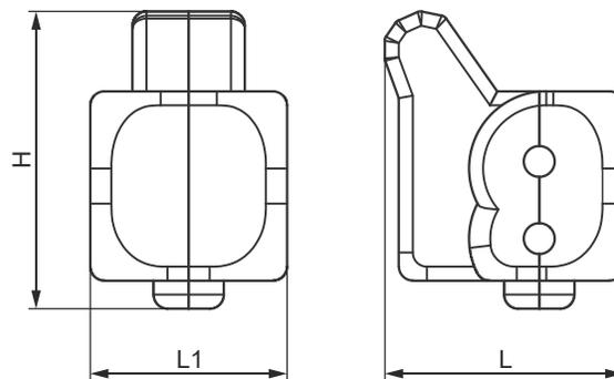
H = Hauteur totale de la vanne avec coquille d'isolation par rapport au mur ou plafond pour montage, raccordement, exploitation, entretien, etc.
