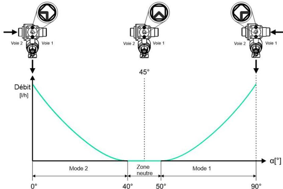
Attention : l'angle de la vanne  $\alpha$  [°] se déplace dans le sens trigonométrique. Les servomoteurs GDB161.9../.6.. tournent par défaut dans le sens trigonométrique. Par conséquent :
