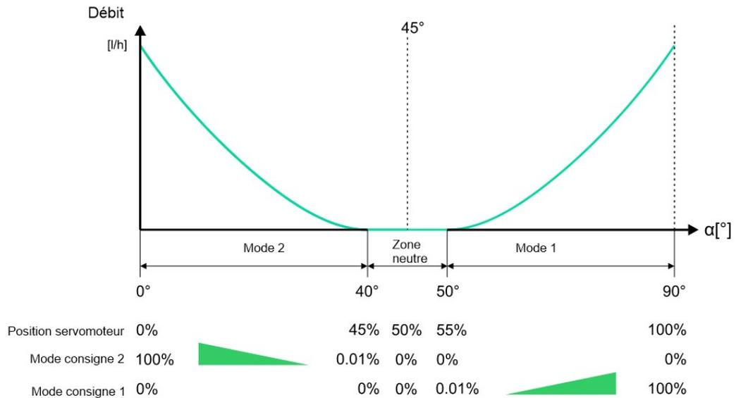
On peut choisir librement la répartition pour le chauffage et le refroidissement. Siemens recommande toutefois pour des raisons de sécurité d'adopter une répartition identique sur toutes les vannes lors de l'installation (cf. ci -dessous):
