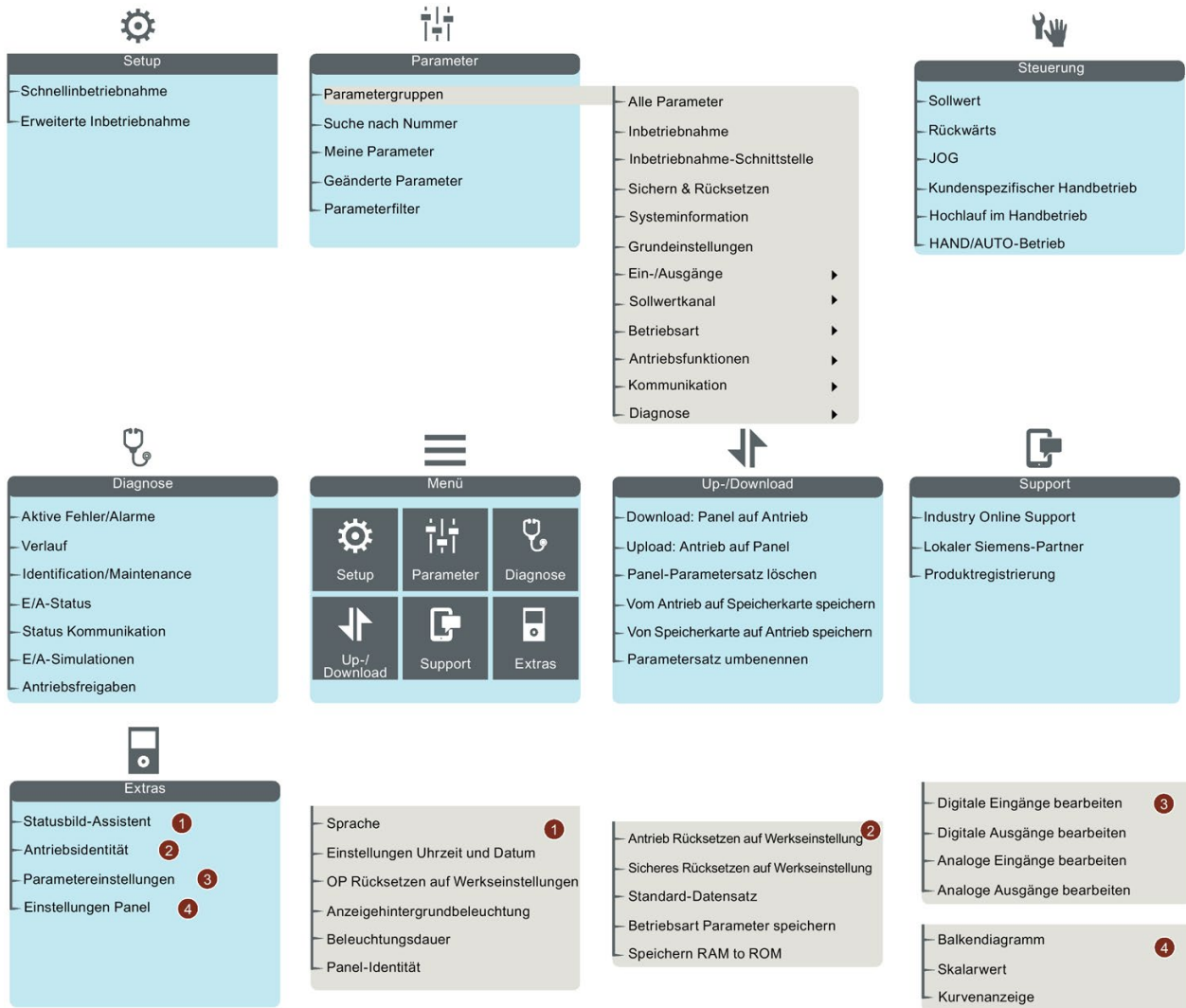
Bild 4-3 Menüstruktur des IOP-2
