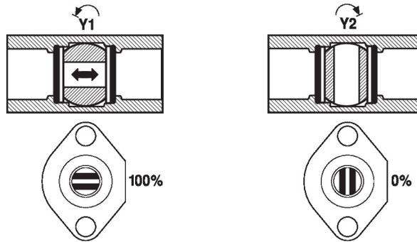
**Réglage de débit** L'angle de rotation du servomoteur est réglable, à l'aide d'un clip, par paliers de 2.5°. Cela est utilisé pour le réglage de la valeur de kvs (débit maximum de la vanne)
