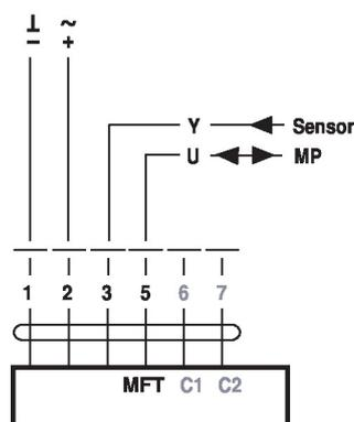
Raccordement de capteurs actifs
