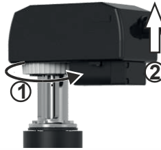
Abb. 5. Demontage des Stellantriebs
