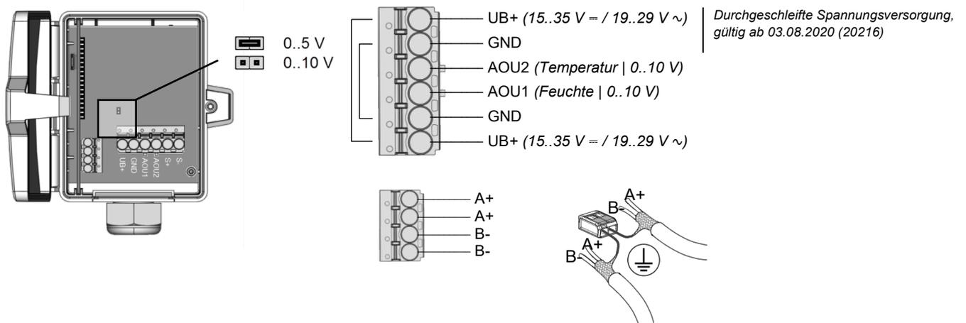
Die Modbus Adresse des Geräts wird über einen 5-fach Dipschalter binärcodiert im Bereich von 1...31 eingestellt. Mit Adresse 0 über DIP ist ein erweiterter Adressbereich (32..247) via USEapp verfügbar.
