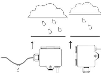
Bei Montage im Außenbereich, direkten Regenschlag und Sonneneinstrahlung vermeiden. Gegebenenfalls Sonnen- bzw. Regenschutz verwenden. Kabeleinführung von unten oder seitlich. Bei seitlicher Kabeleinführung Schlaufe legen, damit Niederschlag definiert abtropfen kann. Beim Einsatz sind die zulässigen Umgebungsbedingungen zu berücksichtigen.
