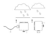
Bei Montage im Außenbereich, direkten Regenschlag und Sonneneinstrahlung vermeiden. Gegebenenfalls Sonnen- bzw. Regenschutz verwenden. Kabeleinführung von unten oder seitlich. Bei seitlicher Kabelzuführung Schlaufe legen, damit Niederschlag definiert abtropfen kann. Beim Einsatz sind die zulässigen Umgebungsbedingungen zu berücksichtigen.
