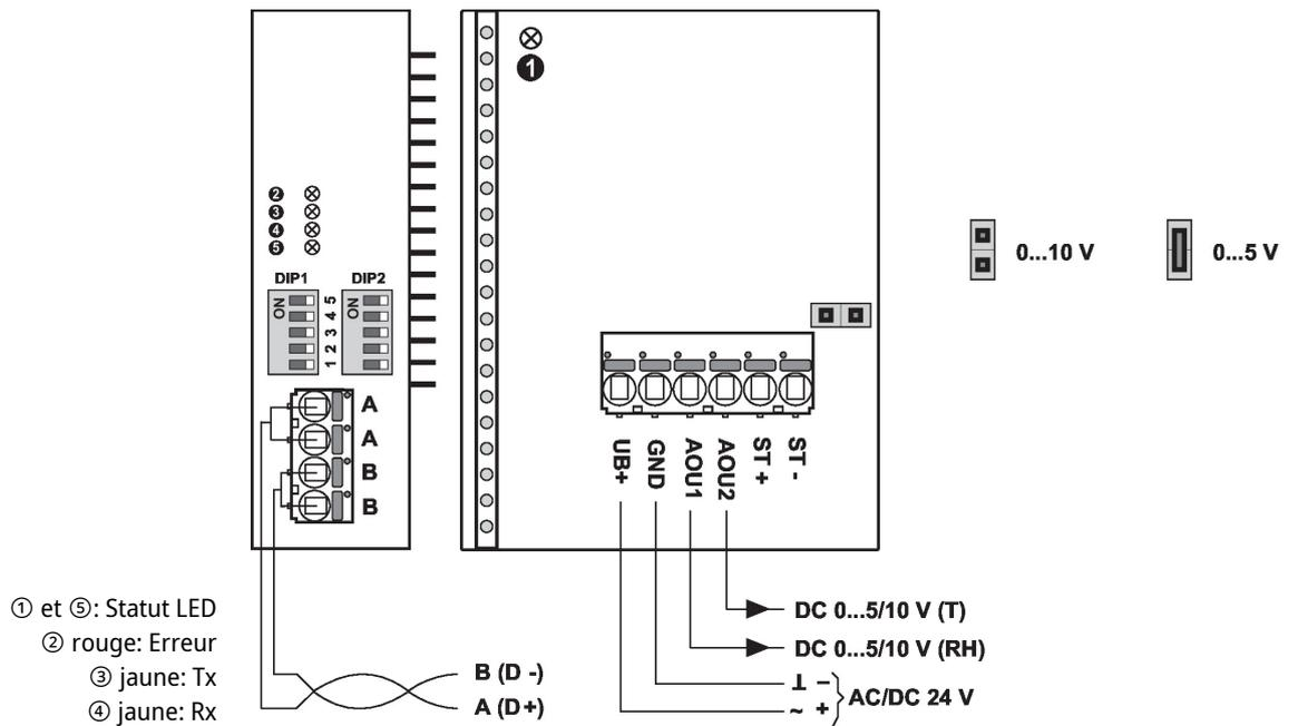
Les connecteurs ST+ / ST- sont uniquement utilisés pour les types de capteur qui disposent par ailleurs d'un élément de capteur de résistance passif pour la mesure de température.
