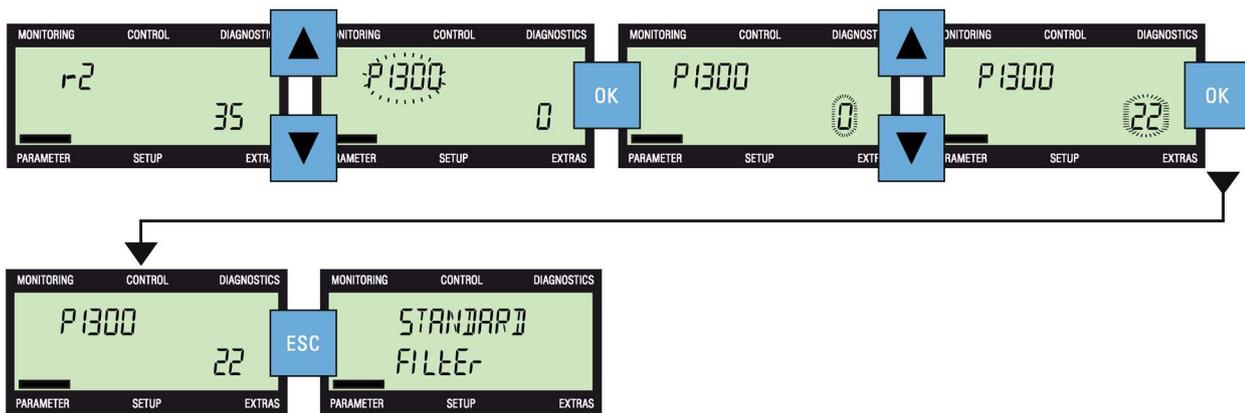
Bild 9-3 Ändern von Parametern (Scroll-Methode)
