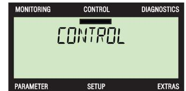
Damit auf die Funktionen zugegriffen werden kann, muss sich der Umrichter in der Betriebsart HAND befinden. Wenn sich der Umrichter nicht in der Betriebsart HAND befindet, wird dies auf dem Bildschirm angezeigt (NO HAND).
