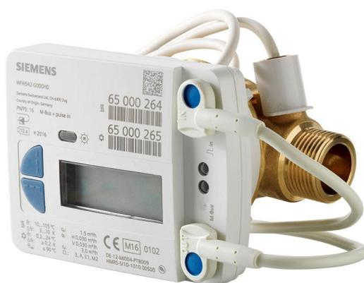
**Elektronische, netzunabhängige Flügelrad-Wärmezähler mit optionalem Kältebereich zur Erfassung des Wärme- oder Kälteverbrauchs in autonomen Heizungs-, Kühlungs- oder Solaranlagen.**
