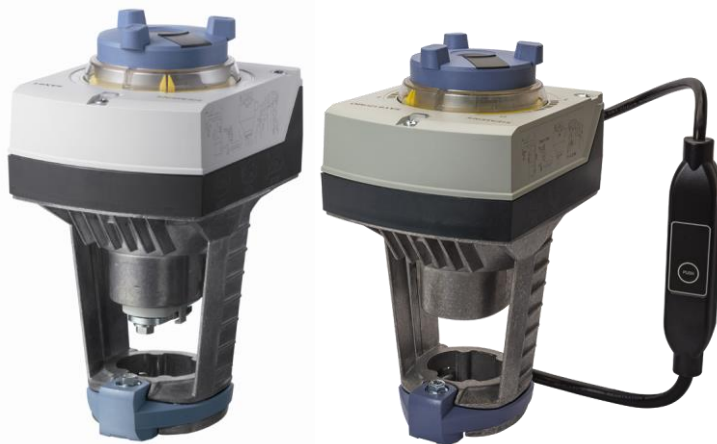
Servomoteurs avec course de 15 mm et force de 200 N
