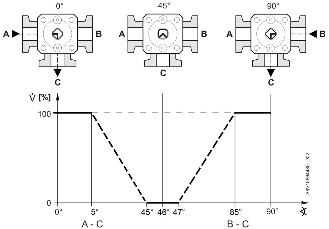
La vanne à boisseau sphérique à 6 voies permet de permuter entre deux sources grâce à ses positions 0° et 90°. A 45°, la vanne est fermée.
