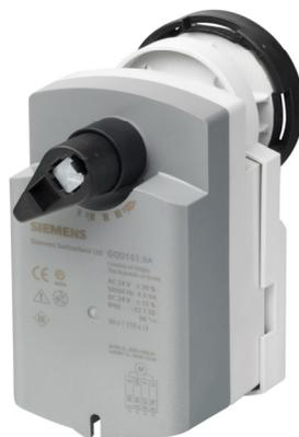
**Elektromotorische Drehantriebe mit Federrücklauf für Notstellfunktion, für 2-Punkt-, 3-Punkt- und stetig wirkende Steuerung. Einsatz in Heizungs-, Lüftungs- und Klimaanlage.**
