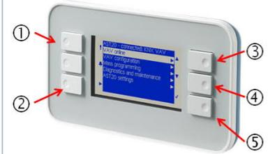
Hinweis: Nach Drücken von EINGABE werden geänderte Werte direkt in den angeschlossenen VAV-Kompaktregler geschrieben
