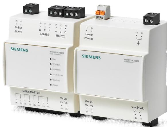
**Der Pegelwandler/Repeater WTX631-GA0090 dient als Schnittstelle zwischen M-Bus Geräten und einem Auslesesystem. Er besteht aus einem Pegelwandler und der dazugehörigen Spannungsversorgung.**
