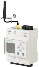
Le serveur Web permet de relever des compteurs M-Bus filaires et RF à l'aide d'un navigateur via Ethernet ou Internet.
