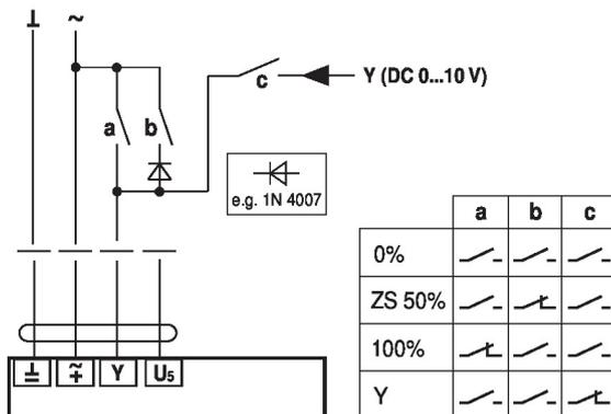
Commande forcée avec alimentation AC 24 V par un commutateur rotatif
