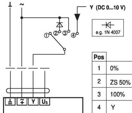
Commande à distance 0 - 100 % (avec positionneur)
