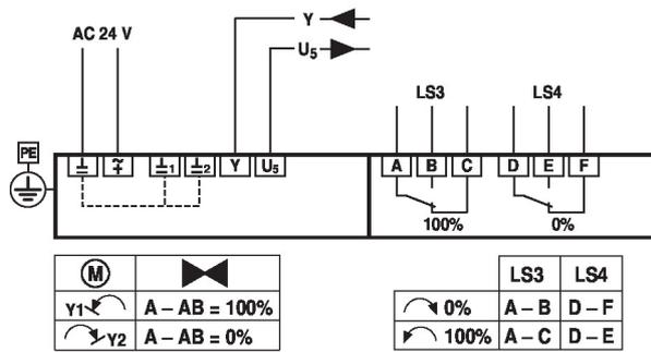
Raccordement 4 fils Raccordement de système à 4 fils
