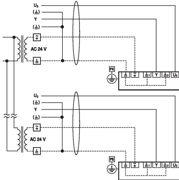
Installation électrique pour raccordement à 3 fils
