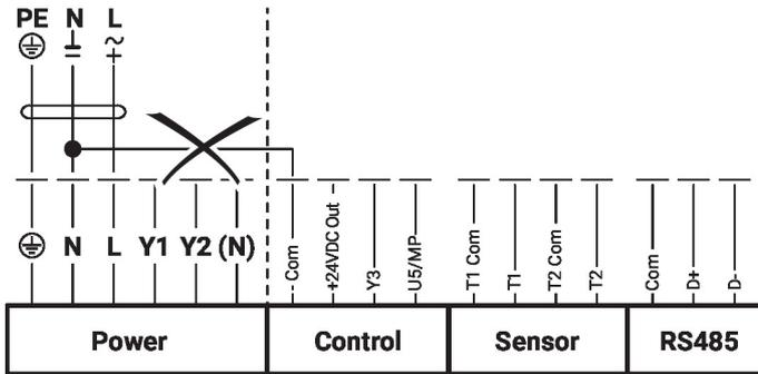
L'alimentation électrique ne doit pas être raccordée aux bornes de commande !
