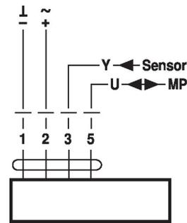
Raccordement de capteurs actifs
