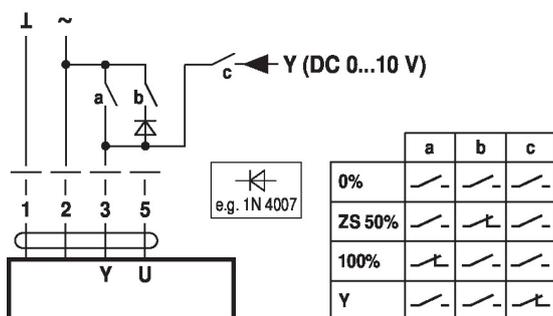
Commande forcée avec alimentation AC 24 V par un commutateur rotatif
