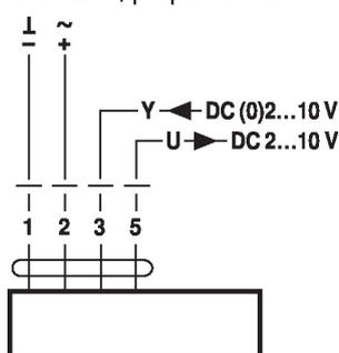
Raccordement de capteurs actifs
