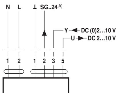
A) Alimentation auxiliaire uniquement pour positionneur SG..24
