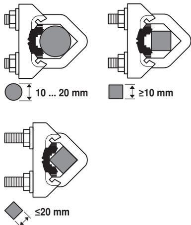
Lors de l'utilisation d'un axe rond constitué de CrNi (INOX) :  $\varnothing$  12...20 mm
