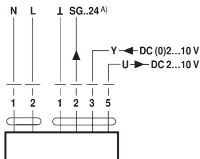
A) Alimentation auxiliaire uniquement pour positionneur SG..24
