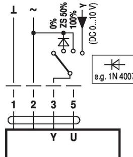
Commande à distance 0 - 100 % avec positionneur SG.
