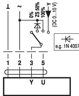
Commande à distance 0 - 100 % avec positionneur SG.
