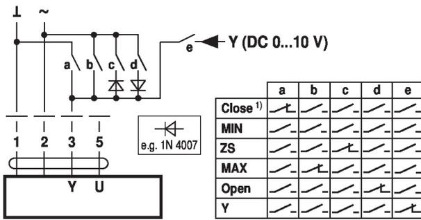
Commande forcée et limitation avec alimentation AC 24 V par un commutateur rotatif
