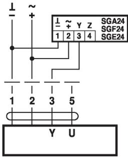
Limitation minimale avec positionneur SG.
