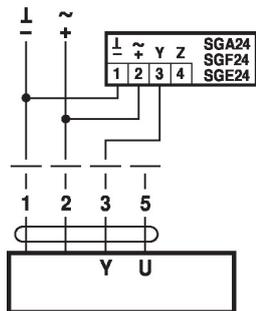
Limitation minimale avec positionneur SG.
