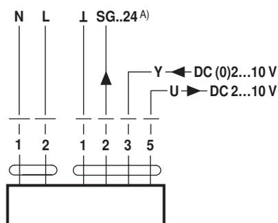
A) Alimentation auxiliaire uniquement pour positionneur SG..24
